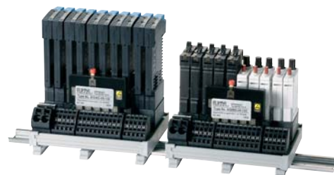
Gli SVS09 in cascata forniscono protezione selettiva con modulo di segnalazioni integrato, equipaggiato con interruttori tipo ESS20, 2210 e 3600.
